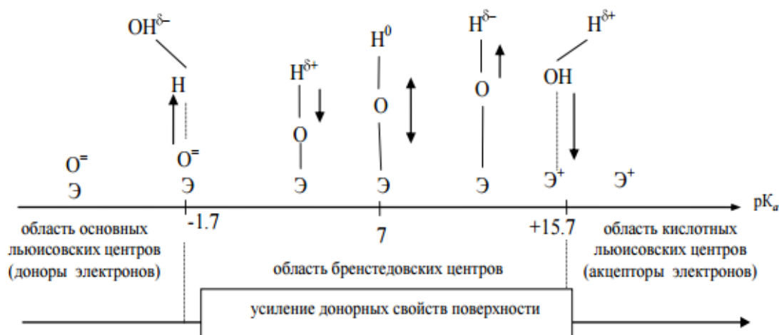
Рисунок 2.4 - Формальная схема расположения кислотно-основных центров поверхности по силе и типу (Моррисон, 1980)
